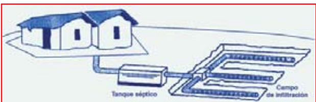
Fig. 20. Zanja de infiltración.
